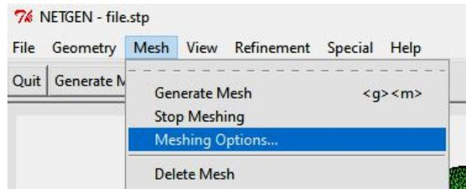
es erscheint eine neue Dialogbox dort Register „Mesh Size“ wählen und die unten gezeigte Einstellung übernehmen, dannach im Hauptmenü mit „Generate Mesh“ ein FEM-Netz aus 17 549 Knoten und 69 879 TET4-Elementen generieren.
