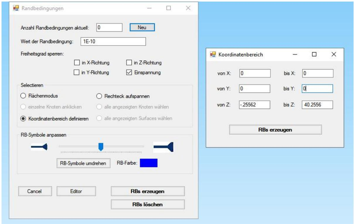
Schalten Sie Register „Ansicht“ und „Drahtgitter“ mit „FEM-Netz“ ein damit die eingespannten Knotenpunkte durch den Nullpunkt auch zu sehen und überprüfbar sind.
