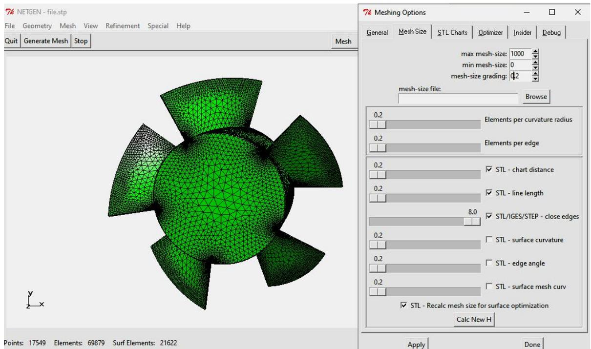
Nach der Netzgenerierung wählen Sie Menü „File“ und „Export Mesh“ und exportieren das FEM-Netz mit Namen „test.fem“ in das voreingestellte Verzeichnis ...Debug/mesh. Das Verzeichnis nicht verändern ansonsten funktioniert die automatische Einladung in MEANS V12 nicht mehr.
