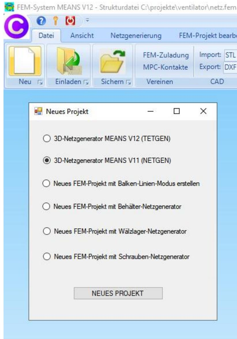
Wählen Sie Menü „Neues Projekt“ und stellen mit dem Browser das Verzeichnis ein indem sich die STEP-Datei „ventilator\_grabcad\_cf.stp“ befindet. Selektieren Sie diese und starten mit Menü „Netzgenerator mit CAD-File starten“ den Netzgenerator NETGEN.
