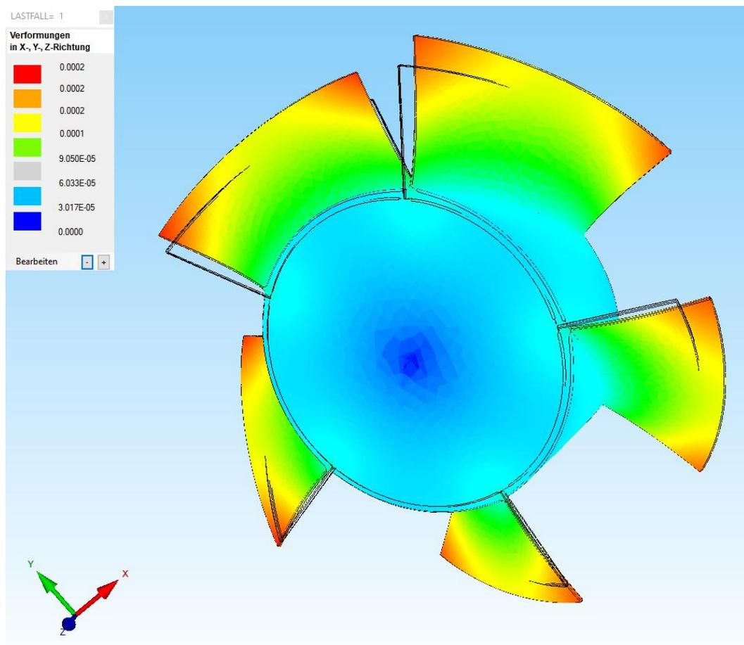
**Max. v.Mises-Vergleichsspannung = 2.19 N/mm<sup>2</sup>**
