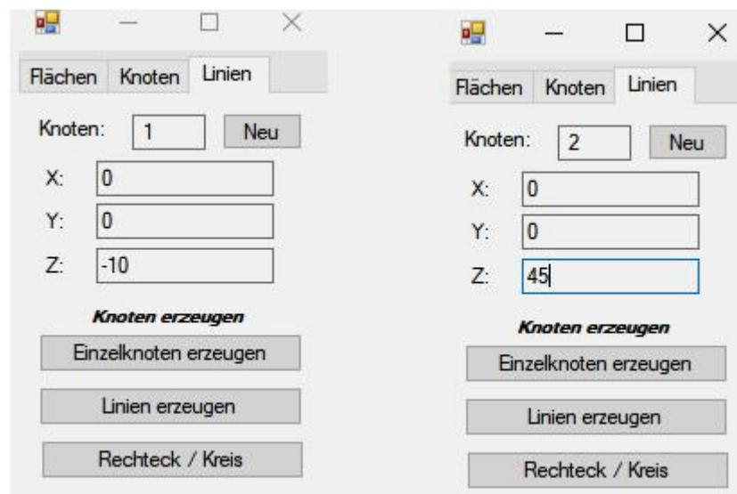
Wählen Sie „Linie erzeugen“ und verbinden Knoten 1 und 2 mit der Anzahl 25 Knoten pro Linie und speichern die Linie unter „Balken.fem“ ab.
