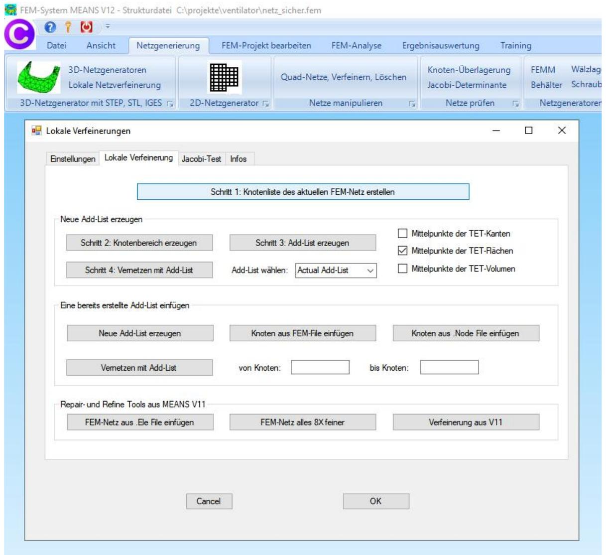
Falls eine Fehlermeldung im Netzgenerator erscheint hat man wahrscheinlich Schritt 1 übersehen, dann einfach nochmals das ursprüngliche Ventilator-Netz einladen und Schritt 1 ausführen und dann das Balken-Modell einfügen und neu vernetzen.
